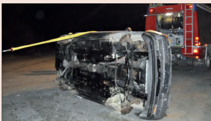
Übung beim Bauhof – Absichern und Bergen von verunfallten Fahrzeugen, Verwendung des Greifzuges mit entsprechenden Sicherungen.
